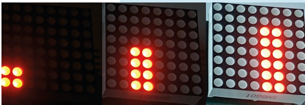
Rysunek 29 Przykład wyświetlania matrycy LED dla trzech pierwszych poziomów światła
