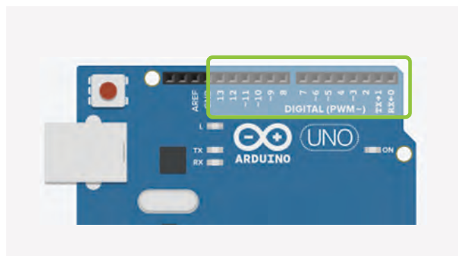
Rysunek 9 Arduino i piny cyfrowe (Digital) od 0 do 13.
