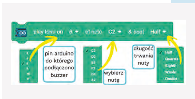
Rysunek 11 Budowa bloczku kodu odpowiadającego za odtwarzanie nut
