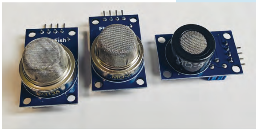
Rysunek 85 Przykłady różnych czujników powietrza MQ-135, MQ-2, MQ-9.
