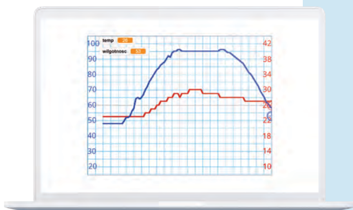
Rysunek 77 Przykładowy wykres, przedstawiający dane z czujnika, na który dmuchano w bliskiej odległości.
