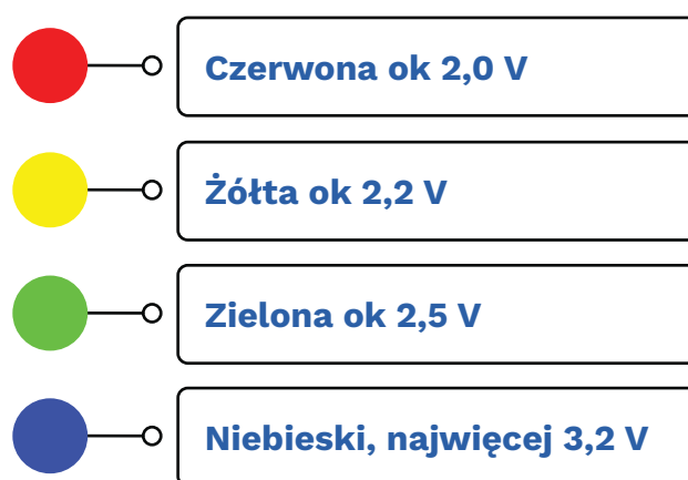
Rysunek 1 kolory diod i wymagane przez nie napięcie
